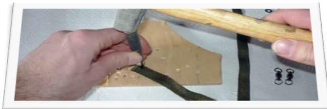
15мм, а со стороны концов - 4-5мм. Я настоятельно рекомендую пользоваться специальными пробойниками (как на фото) или хотя бы шилом. Это обеспечит ровные кромки отверстия и оно не будет в дальнейшем расходиться по швам.
